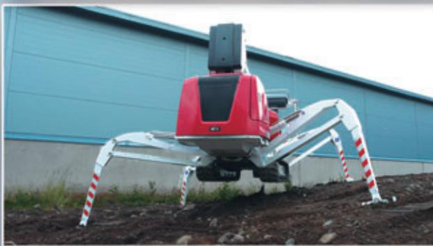
Nivellierbar bis zu einer Geländeneigung von max. 16°.
