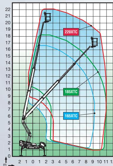
Die DINO XTC Raupenbühnen sind speziell für äußerst anspruchsvolle Einsatzbedingungen im Gelände sowie für den Indoor-Betrieb konzipiert.
