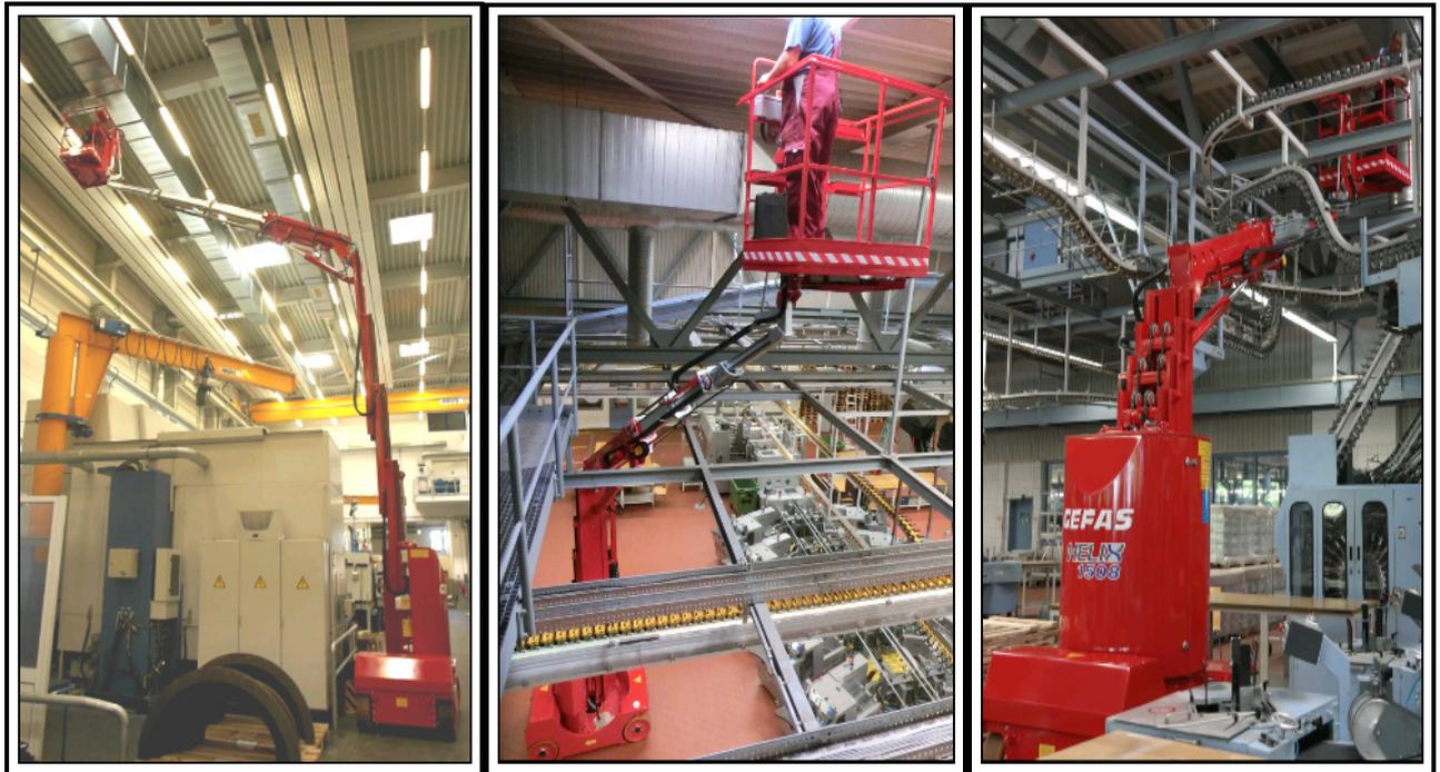
Es handelt sich um eine elektrisch betriebene, kompakte, selbstfahrende Gelenk-Teleskop-Arbeitsbühne mit Korbarm (Arbeitshöhe bis 15 m), welche speziell für Wartungs- und Instandhaltungsarbeiten in beengten Bereichen entwickelt wurde.
